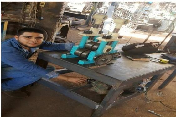
Proyecto de Residencias con el objetivo de resolver problemas en la empresa ejemplo: Diseño, construcción e implementación de Máquina Roladora de Solera para la fabricación de Bidas en el Área de Manufactura para a la empresa **Bombas Invasa**
